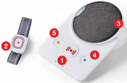
Ein Druck auf die **Notfalltaste 1** oder den **Funksender 2** baut eine direkte Verbindung zur rund um die Uhr besetzten Hausnotrufzentrale auf. Das Gespräch erfolgt über eine integrierte **Freisprecheinrichtung 3**.
